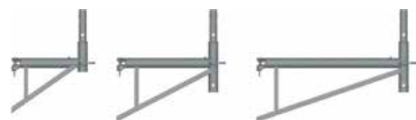
Figure 72 : Vue d'ensemble des consoles extérieures.
