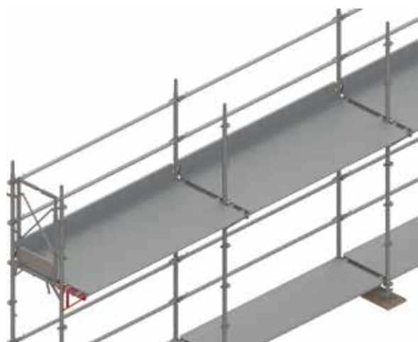
Figure 71 : Niveau d'échafaudage avec consoles intérieures et plateaux.
