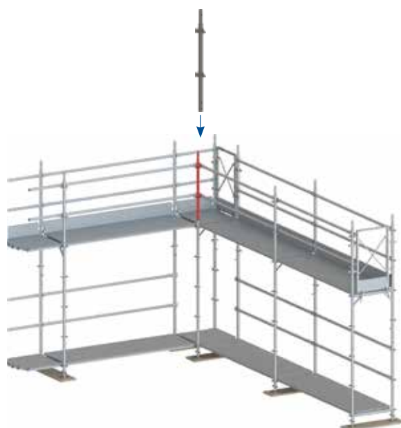
Figure 79 : Solution d'angle, garde-corps intérieur.
