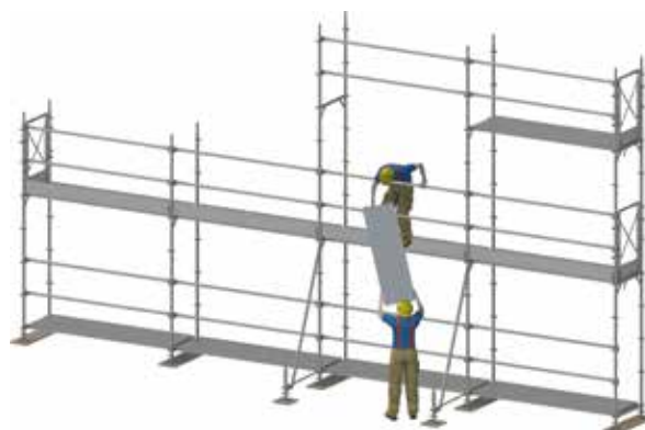
Figure 49 : Exemple d'une sécurité antibasculement temporaire du premier niveau de l'échafaudage.
