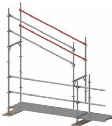
Figure 77 : Soulèvement du cadre en H avec garde-corps intérieur.
