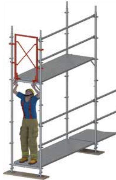
Figure 21 : Positionnement final de l'extrémité frontale et sécurité.
