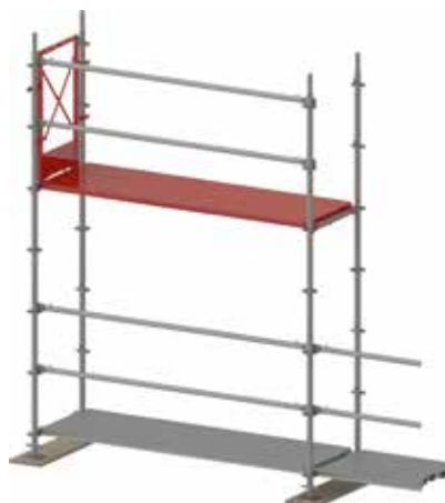
Figure 27 : Champ d'échafaudage entièrement monté.
