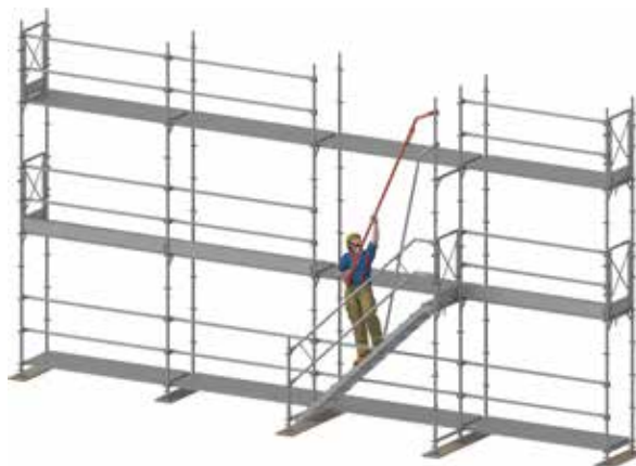
Figure 43 : Montage des mains courantes d'escalier.
