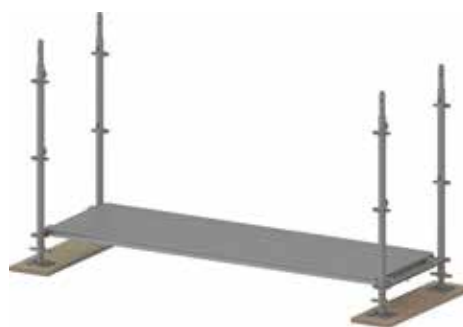
Figure 4 : Support de répartition des charges avec madriers.
