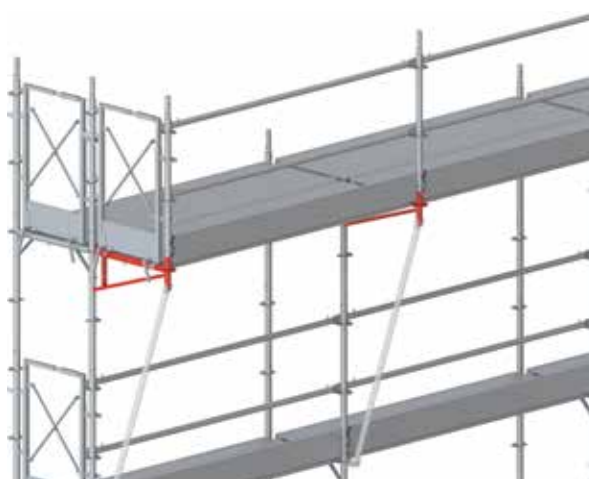
Figure 73 : Niveau d'échafaudage avec consoles extérieures et plateaux.
