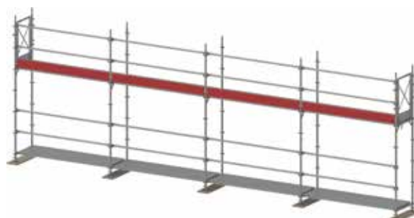
Figure 28 : Niveau d'échafaudage entièrement monté avec plinthes.
