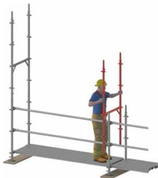
Figure 13 : Montage cadre en H en position maintien.
