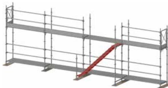
Figure 36 : Montage de l'escalier.
