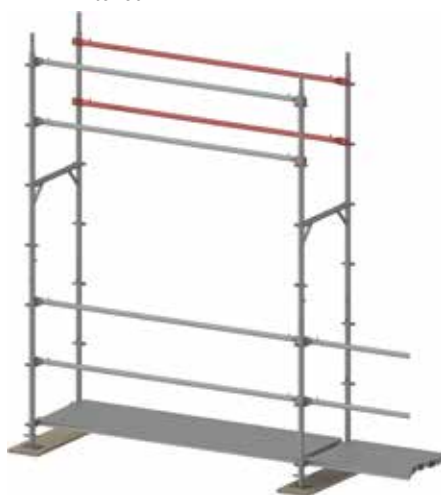
Figure 78 : Position finale du garde-corps intérieur.
