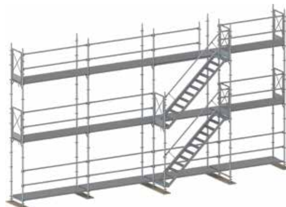
Figure 48 : Accès par escalier terminé.
